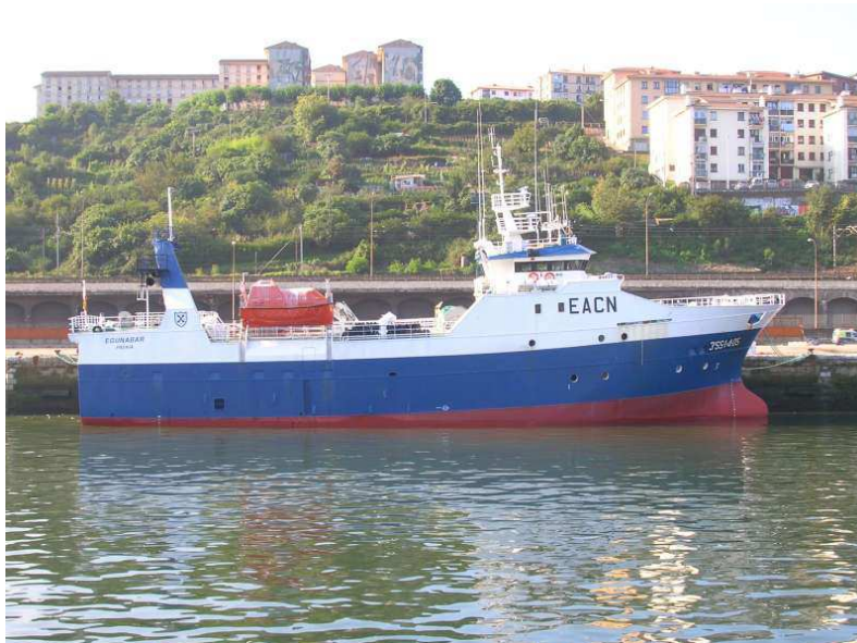
Egunabar , moderno rampero de la compañía Laurak Bat construido en 2006 en los Astilleros de Vigo. Posee una eslora de 47,75m y un arqueo de 703 Tm de registro bruto. Con base en el puerto de Pasaia se dedica a la pesca del bacalao en Noruega mediante el sistema de congelado.
