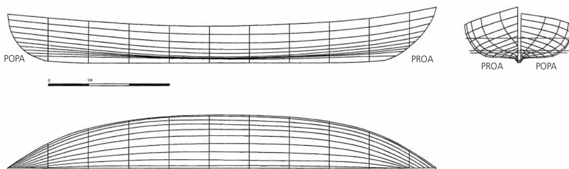
Reconstrucción hipotética del pecio de Urbietta elaborada por Eric Rieth y Marc Ginisty (2004).
