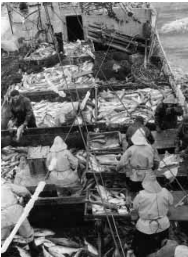
Cubertada en el bacaladero Mari de la empresa Cirimar, c.1960. Obsérvese la disposición típica de un parque de trabajo en un parejero. A la izquierda los descabezadores, a la derecha, repartidos en mesas por parejas, los tronchadores y sacaspinas. Colección Miguel Ciriza.
