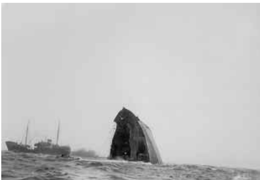
Hundimiento del bou Tifón de la PYSBE tras su colisión con el Invicta portugués, mayo 1955. "El Invicta iba filando a toda máquina y el Tifón estaba parado para virar. El capitán portugués entró en el cuarto de ruta y para cuando quiso darse cuenta le metió la proa por toda la banda de babor, a la altura de la cámara de máquinas. El Tifón, que iba bien cargado, se fue a pique en 11 minutos. Los supervivientes fueron recogidos por barcos portugueses, el Alvaro Martín Omes principalmente. Una hora después de rescatada la tripulación levantó muy mala mar. Si llega a ser en ese momento allí no se salva nadie". Foto cedida por José Miranda Dorronsoro. Archivo Untzi Museoa.
