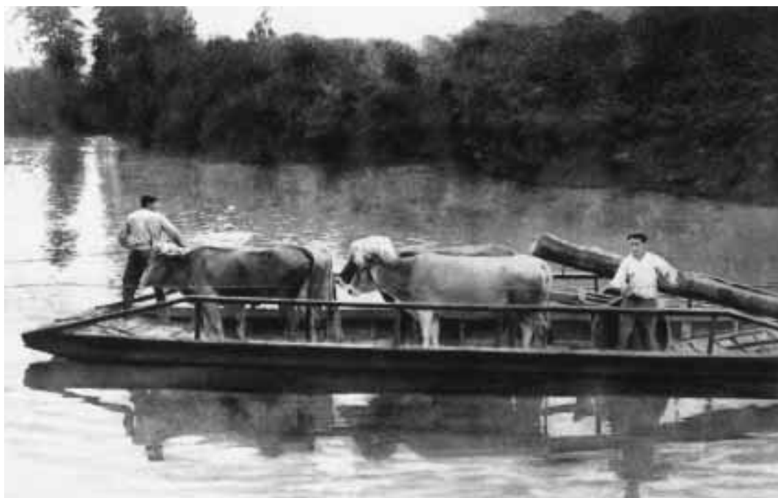
Paso de gabarra o ala-aundi por el Oria (Andoain). Se aprecia que la tracción se efectúa mediante cuerdas situadas a babor y estribor. Foto Urcabe. Novedades, 1911.
